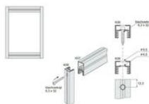
Montaż ramki z profilu adaptacyjnego K06, K01
